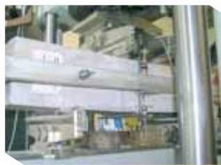
Betón s oceľovou výstužou / porušenie po vzniku trhliny
